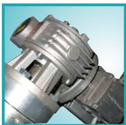
Motore con trasportatore a coclea per l'aggiunta del pellet.
