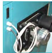
Ammortizzatore per sollevare e abbassare più facilmente la porta della caldaia / Interruttori della caldaia / Regolazione della caldaia / Ventilatore per l'aspirazione dei fumi di scarico, connettore per la pompa e sensore /
