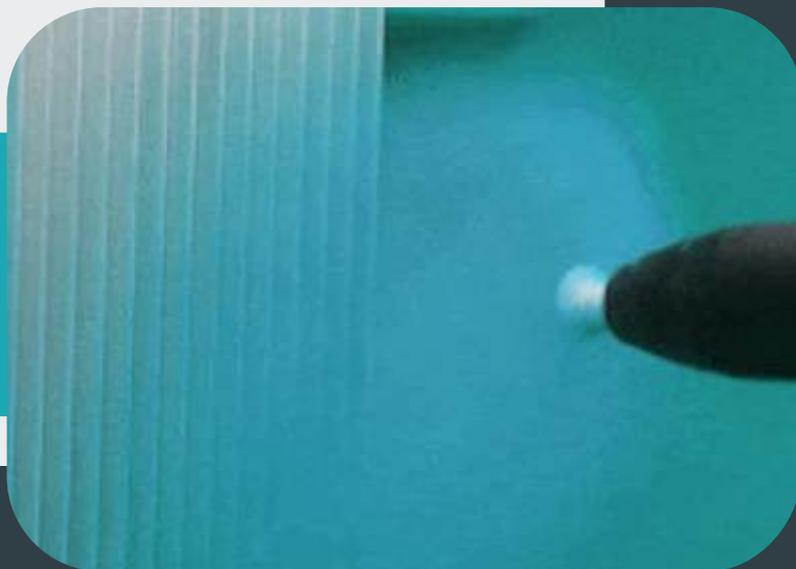
Elektrostatsko nanošenje praha ili plastificiranje metala je postupak površinske zaštite metala od korozije, kojim se osigurava dugotrajna površinska zaštita svih vrsta metala. Ovaj postupak produžava trajnost metala u agresivnim okolišima. Termičkim ili elektrostatičkim putem nanosi se plastifikat, stvarajući čvrst i estetski privlačan sloj. Prednosti uključuju otpornost na vanjske utjecaje, široku paletu boja te mogućnost prilagodbe različitim dizajnerskim potrebama.
