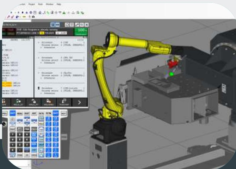
Robotsko zavarivanje je automatizirani proces koji koristi industrijske robote za izvođenje zavarivačkih operacija. Ovaj tehnološki napredan pristup omogućava visoku preciznost, dosljednost i efikasnost u zavarivanju metalnih komponenta. Koristi se MAG pulsno zavarivanje te Servo-Robot laserske kamere za očitavanje koje kod zavarivanja omogućavaju točnost ponavljanja.
