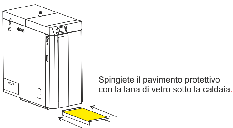
Figura 2.a Pavimento protettivo con la lana di vetro
