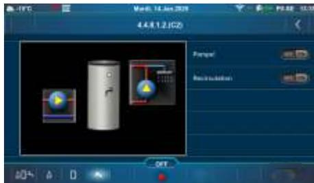
Il faut appuyer sur le bouton "ON" à côté du symbole de la pompe/vanne que vous souhaitez vérifier. Le symbole de la pompe commencera à tourner et le bouton s'allumera en vert. En appuyant sur le bouton "OFF", la pompe s'arrêtera.
