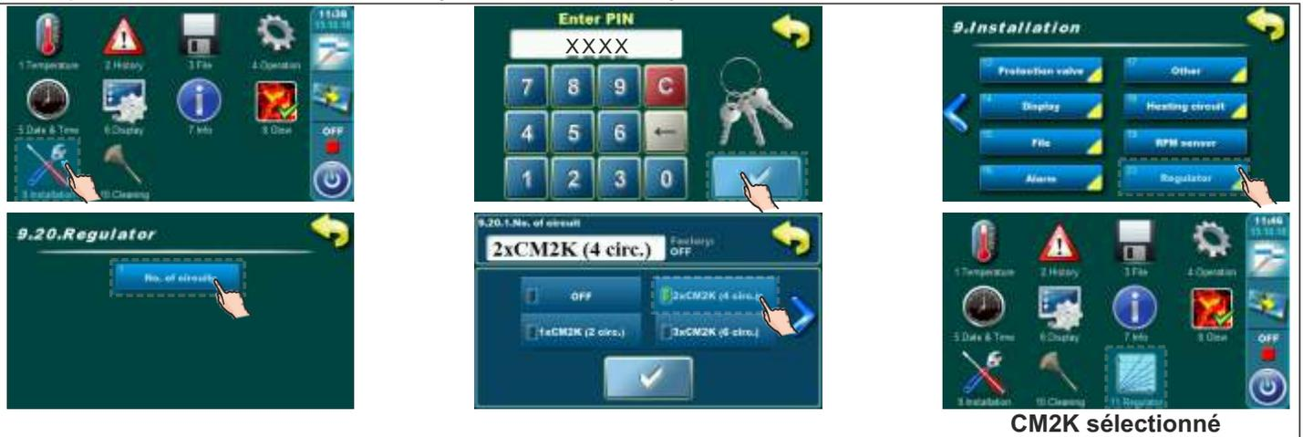
Exemple de sélection CM2K: Cm Pelet-set Touch (1xCM2K - 2 circuits)
