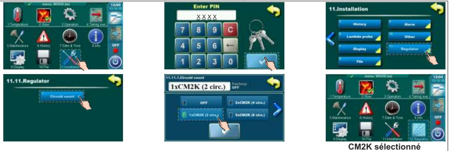
Exemple de sélection CM2K: EKO-CKS P Unit (1xCM2K - 2 circuits)
