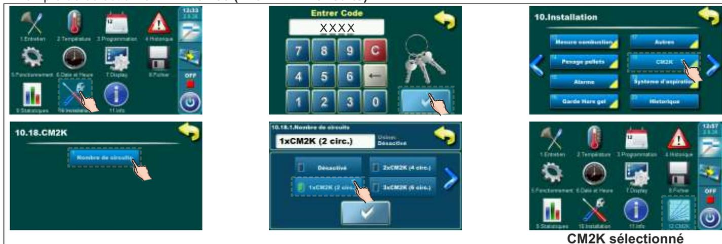
Exemple de sélection CM2K: BioTec-L (2xCM2K - 4 circuits)
