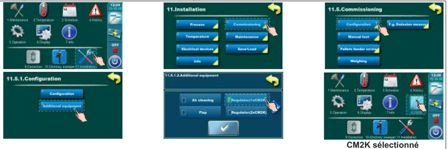
Exemple de sélection CM2K: BioTec Plus (1xCM2K - 2 circuits)
