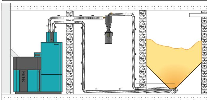
Ciklon se koristi za odstranjanje prašine iz sistema dobave peleta vakuumom kako bi se spriječilo nakupljanje prašine u sezonskom spremniku peleta kroz duže razdoblje korištenja - **LIJEVA IZVEDBA**.
