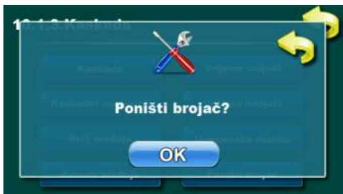
Ovaj parametar omogućuje resetiranja brojača rada kotla. Može se resetirati na svakom kotlu posebno.
