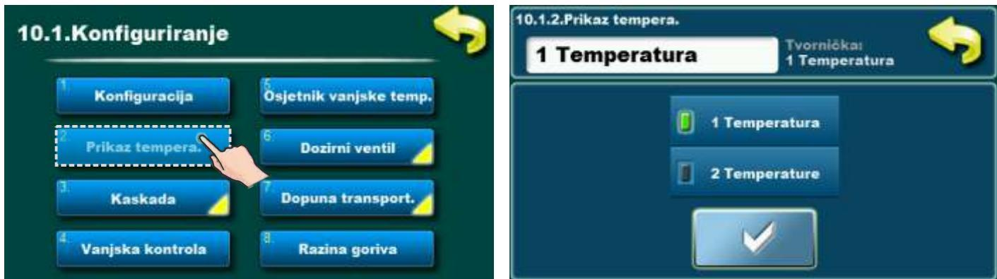
Ako je odabran prikaz "1 Temperatura", na ekranu se prikazuje hidraulička skretnica s 1 temperaturom (**nije moguće za 69/96**).
