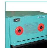
Connettore termostatico per la pompa e attacchi per l'installazione della protezione
