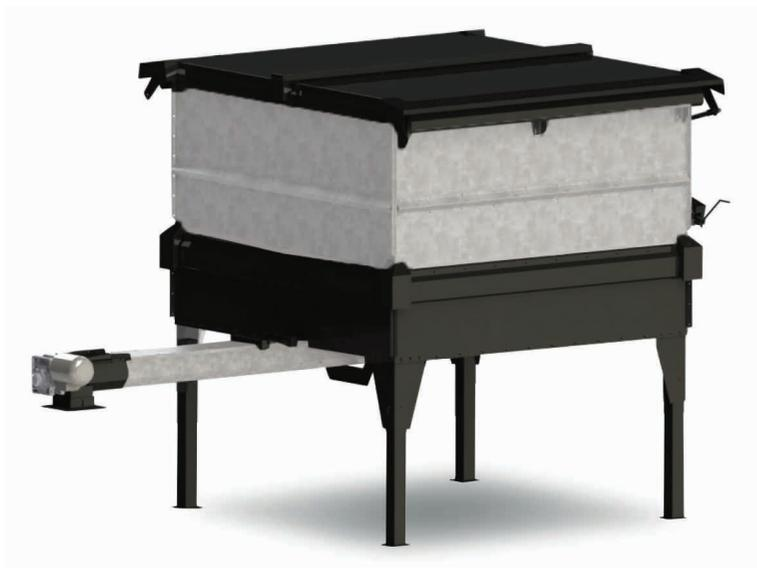
Sono destinati allo stoccaggio e all'alimentazione di cippato a caldaie come BIO-SC o EKO-CKS Multi Plus. Sono realizzati in modo tale da poter essere collocati in uno spazio coperto o all'esterno dell'edificio. Sono dotati di un trasportatore a coclea, di un motore elettrico e di un miscelatore di cippato. I contenitori vengono riempiti dall'alto dopo l'apertura del coperchio e il cippato con cui sono riempiti può avere un'umidità fino al 35%.
