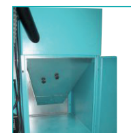
Otvori za čišćenje spremnika
