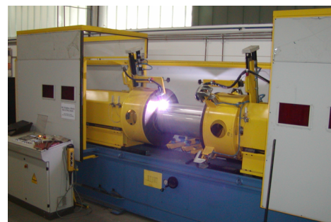
Automatsko zavarivanje bojlera od nehrđajućeg čelika
