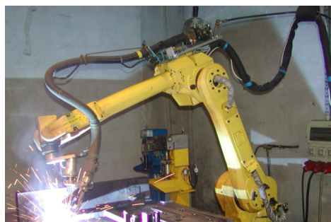
Robotsko zavarivanje kotlova
