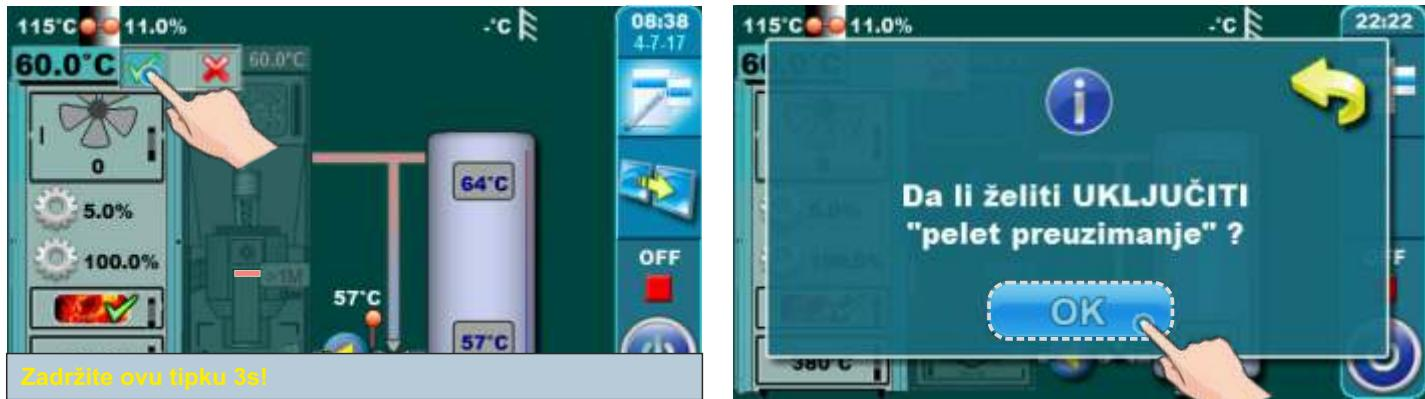
Pritisnuti zeleni indikator na desnoj strani kotla (gorivo: drvo) i držati pritisnuto 3 sekunde. Na ekranu će se ispisati poruka „Da li želite uključiti „pelet preuzimanje“?“. Potvrditi pritiskom na tipku „Potvrdi“.
