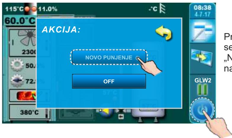
Pritisnite tipku „START / STOP“, na ekranu će se pojaviti prozor s ponuđenim opcijama „NOVO PUNJENJE“ i „GAŠENJE“. Pritisnite na tipku „NOVO PUNJENJE“.
