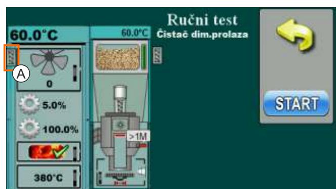
Ova opcija omogućava provjeru rada motora čistača dimovodnih prolaza (čišćenje dimovodnih prolaza). Potrebno je pritisnuti tipku "START" pokraj odgovarajućeg simbola te provjeriti da li radi motor čistača dimovodnih prolaza koji će pokretati turbulatore. Nakon pritiska na tipku "STOP" motor će prestati s radom. Svakim pritiskom na tipku "START" ona postaje "STOP" i obrnuto. Na zaslonu će se simbol za turbulatore (A) pomicati kada je opcija aktivna.
