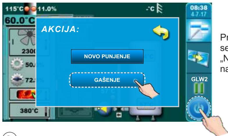
Pritisnite tipku „START / STOP“, na ekranu će se pojaviti prozor s ponuđenim opcijama „NOVO PUNJENJE“ i „GAŠENJE“. Pritisnute na tipku „GAŠENJE“.
