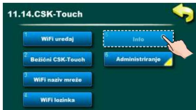
Nakon što smo konfigurirali krugove grijanja na CM2K modulu, potrebno je otvoriti INFO izbornik u CSK-Touch izborniku te zabilježiti CSK-Touch WiFi ID (1) te Adresne kodove (2) (ovisno o broju instaliranih korektora) koje je potrebno upisati u pojedini CSK-Touch prilikom njegovog konfiguiriranja.
