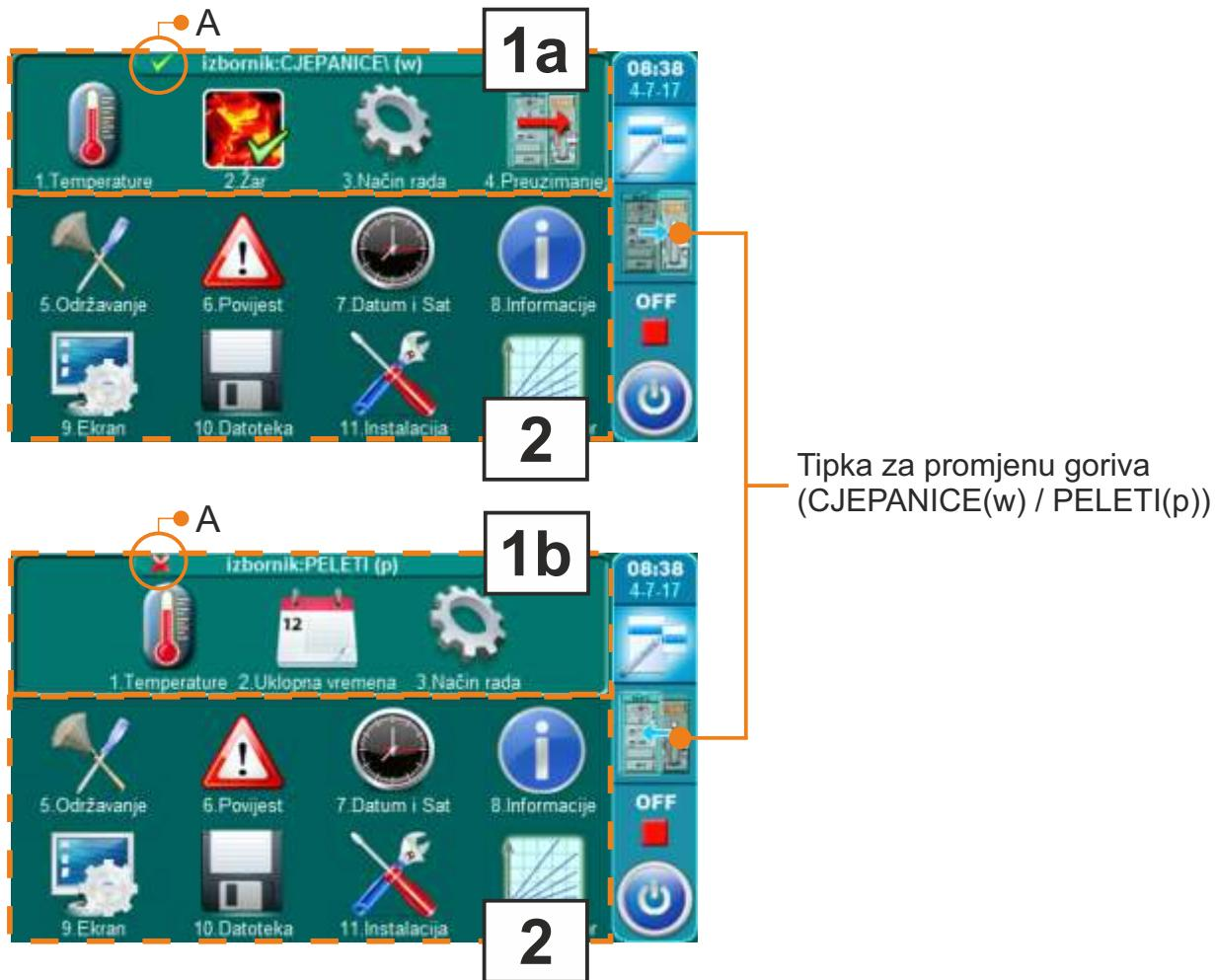
1a - meni CJEPANICE(w) (promjenjivi meni) - meni za korištenje parametara za loženje drvom (lijeva strana kotla)
