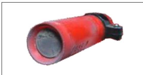
Prljava fotočelija koja može prouzročiti grešku u potpali ili grešku nestanka plamena
