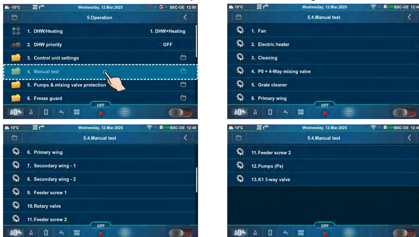
**MANUAL TEST IS POSSIBLE ONLY IF BOILER IS IN PHASE OFF (F).**
