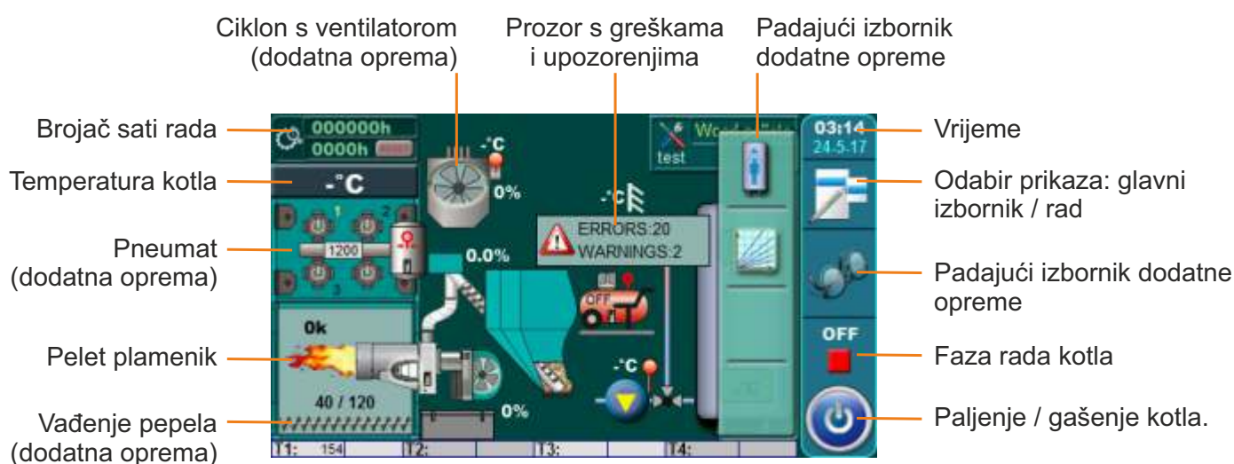
Ekran kotlovske regulacije s dodatnom opremom
