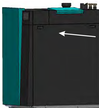
5. Vratite desnu stranicu kotla i ponovno uključite kotao.
