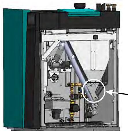
4. Chiudere ermeticamente il coperchio posteriore di pulizia del serbatoio del pellet con le viti.
