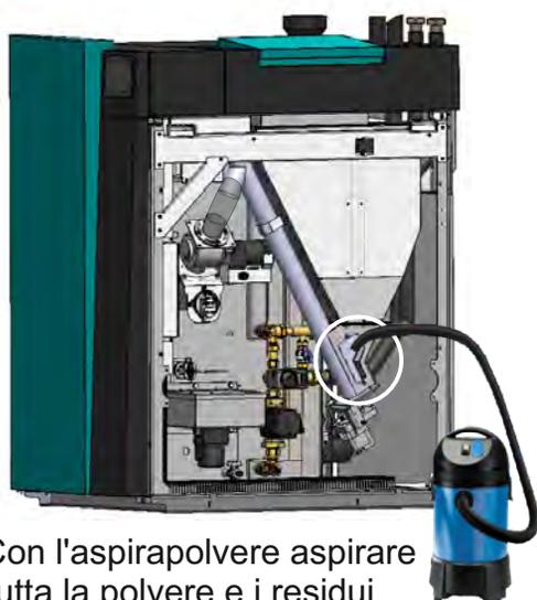
3. Con l'aspirapolvere aspirare tutta la polvere e i residui dal serbatoio del pellet.
