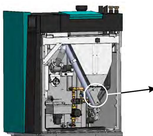
2. Svitare le 2 viti e rimuovere il coperchio laterale del serbatoio del pellet.
