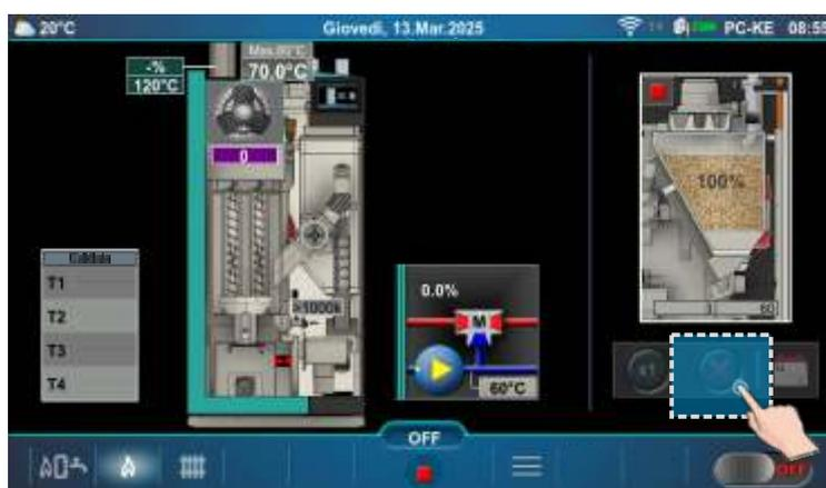
**NOTA:** Dopo lo spegnimento dell'impianto di aspirazione inizia il ciclo di pausa (impostazione di fabbrica 60 secondi), dopodiché l'impianto di aspirazione viene riattivato per riempire il serbatoio del pellet. Se si desidera disattivare il sistema di aspirazione per un periodo di tempo più lungo, è necessario disattivarlo nel menu 10.1.2.4.2. o 4.7.1.
