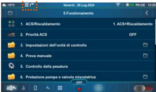
**Solo ACS** - la caldaia funziona solo quando c'è richiesta di acqua calda sanitaria (ACS).
