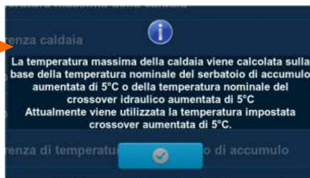
2. Temperatura di crossover idraulico < Temperatura del serbatoio di accumulo
