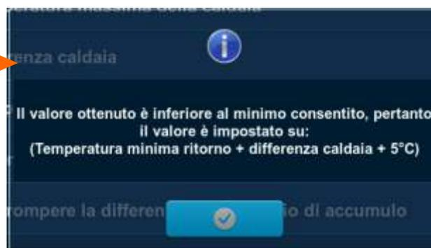
2b. Temperatura del serbatoio di accumulo impostata su < Temperatura impostata ACS
