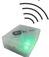
Cm wifi-box (Internet nadzor rada kotla)
