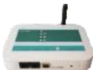
GSM modul za dojavu alarma putem mobilne mreže
