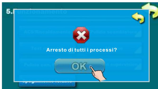
**ATTENZIONE!** Se volete fare l'arresto di tutti i processi, bisogna prima spegnere la caldaia premendo il tasto
