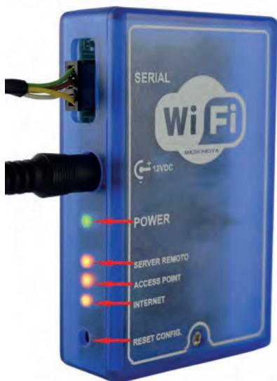
1. Spojite modul na napajanje sa isporučenim adapterom
