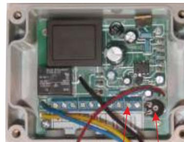
Diferencijalni termostat tvrtke Centrometal namijenjen je ugradnji u solarne sustave i sustave centralnog grijanja gdje je potrebno uključivati tj. isključivati pumpu prema zadanoj (namještenoj) razlici temperatura.
